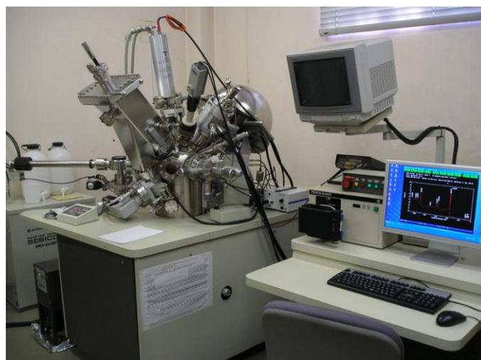
図 X線光電子分光分析装置; ESCA5600
